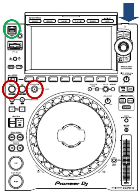
1. 電源 OFF 状態で、USB メモリ、SD カード、LINK 接続及び PC 接続を外し、IN/CUE ボタンと RELOOP/EXIT ボタンを同時に押しながらか電源を ON してください。
